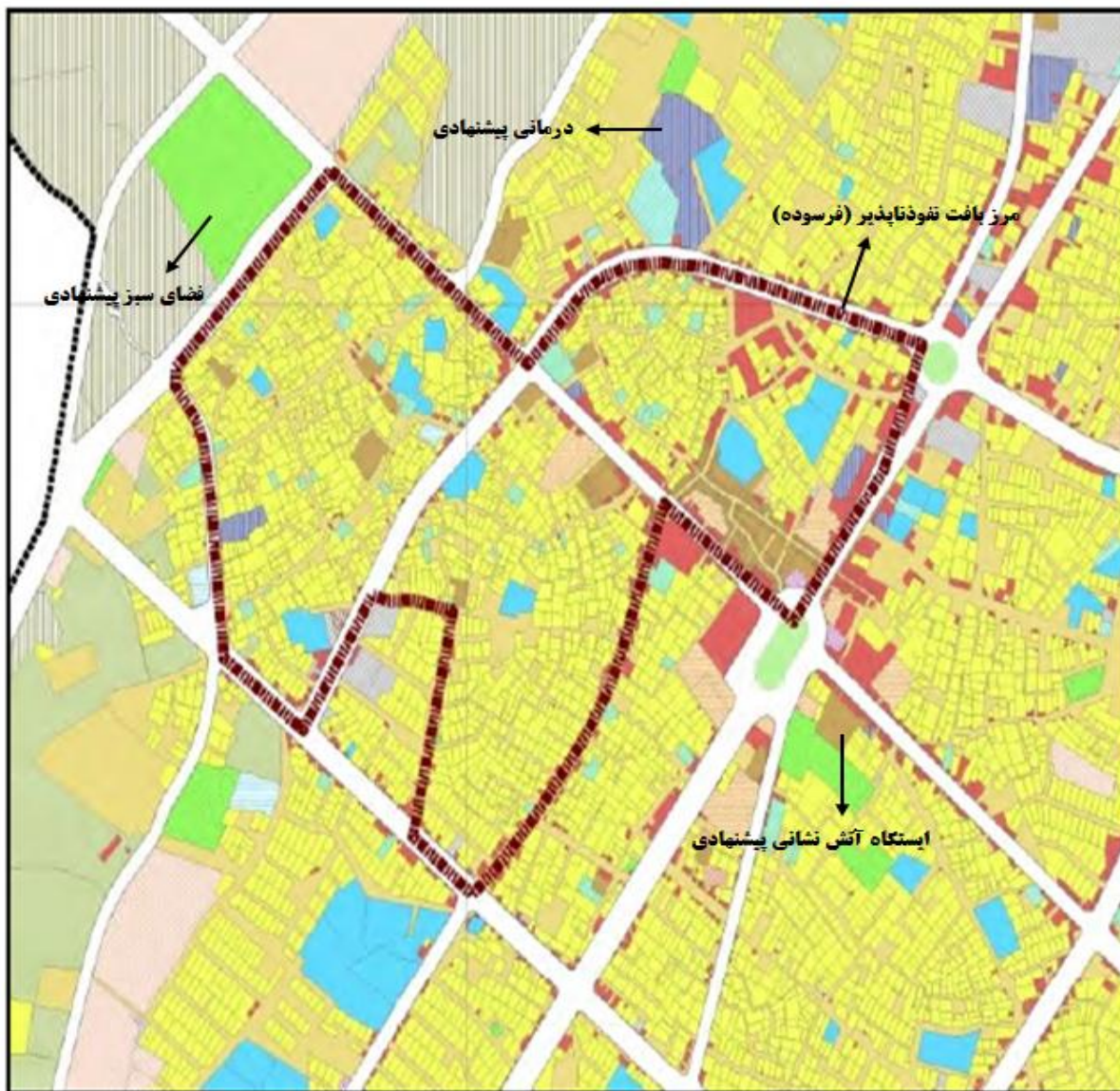
شکل ۶۰- تخصیص کاربری‌های امداد و نجات در پیرامون و مجاور مرز بافت نفوذناپذیر
