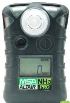
شکل ۴: دتکتور گاز آمونیاک قابل حمل
