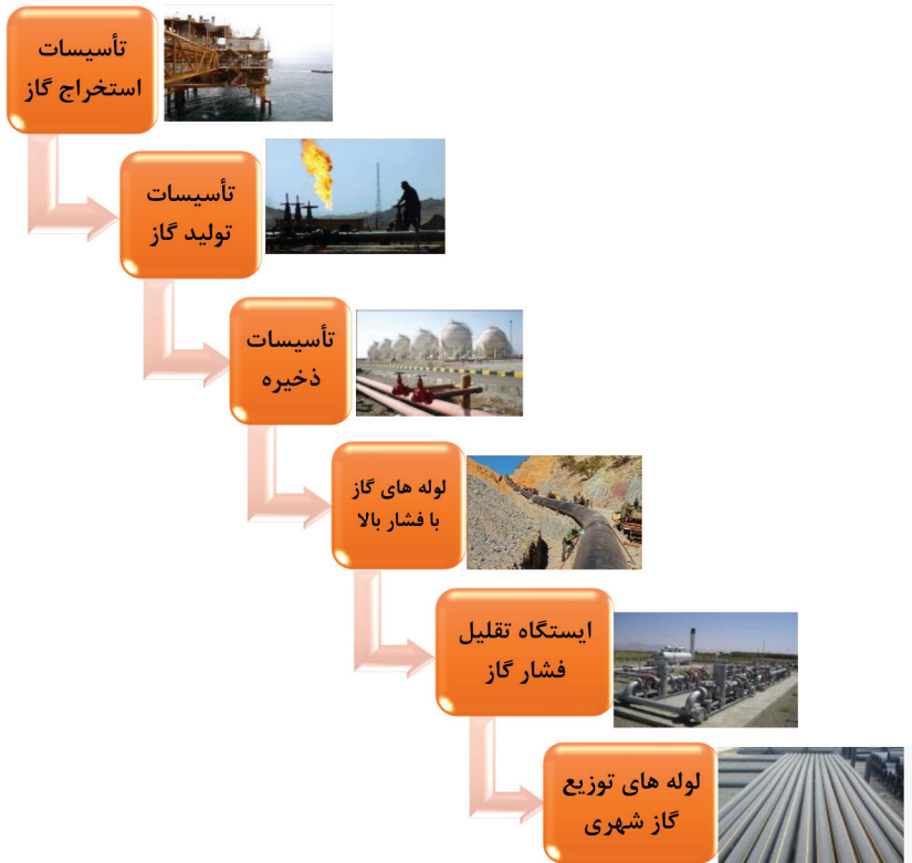
شکل ۲-۹- ترکیب بندی سامانه گازرسانی
