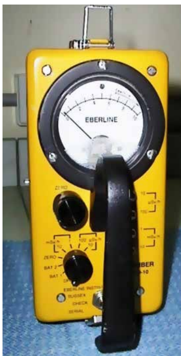
شکل (۴) نمایی از سیستم آشکارسازی اتاقک یونش
