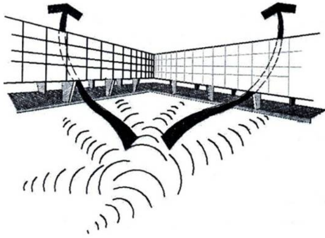
شکل ۲۱-۲-۵- تخلیه موج انفجار از پیلوت باز
